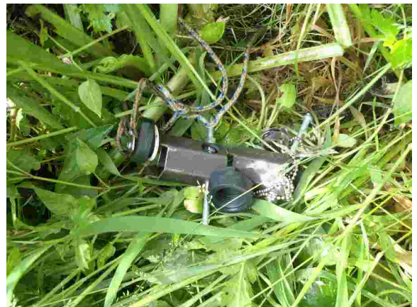
Matériel de mesure de la température (enregistreur + connexion USB + ordinateur + logiciel)
