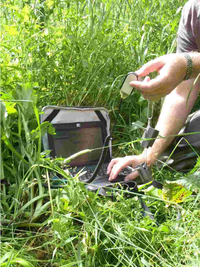
Matériel de mesure de la température (enregistreur + connexion USB + ordinateur + logiciel)
