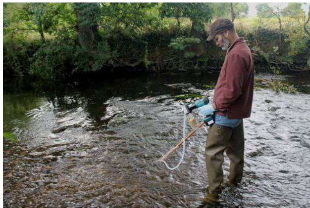
Figure 7. Pompage dans le cours d'eau à l'aide de la pompe péristaltique Vampire .
